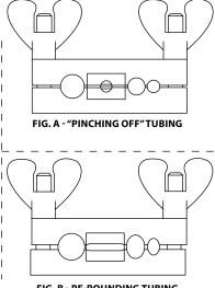
FIG. B - RE-ROUNDING TUBING
