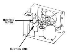
MINIMIZE THE TIME THE REFRIGERATION SYSTEM IS EXPOSED TO THE ATMOSPHERE (15 MINUTES MAXIMUM).
