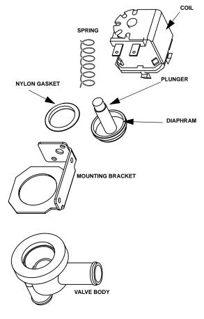
**Dump Valve Disassembly**
